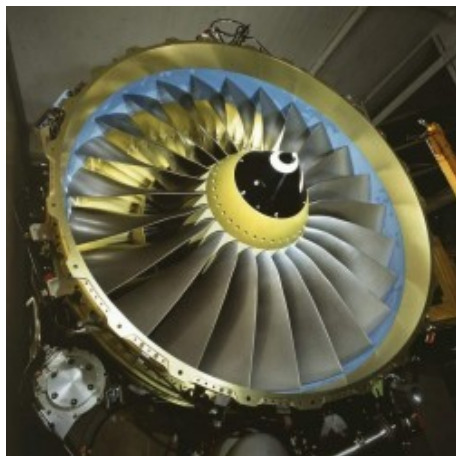
FIGURE 7.3 – Soufflante d'un turboréacteur (a) et schéma de fonctionnement d'un turbofan (b)
